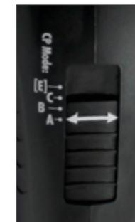
Schiebeschalter mit 4 Stellungen, zur Simulation der CP-Modi A, B, C und E.
