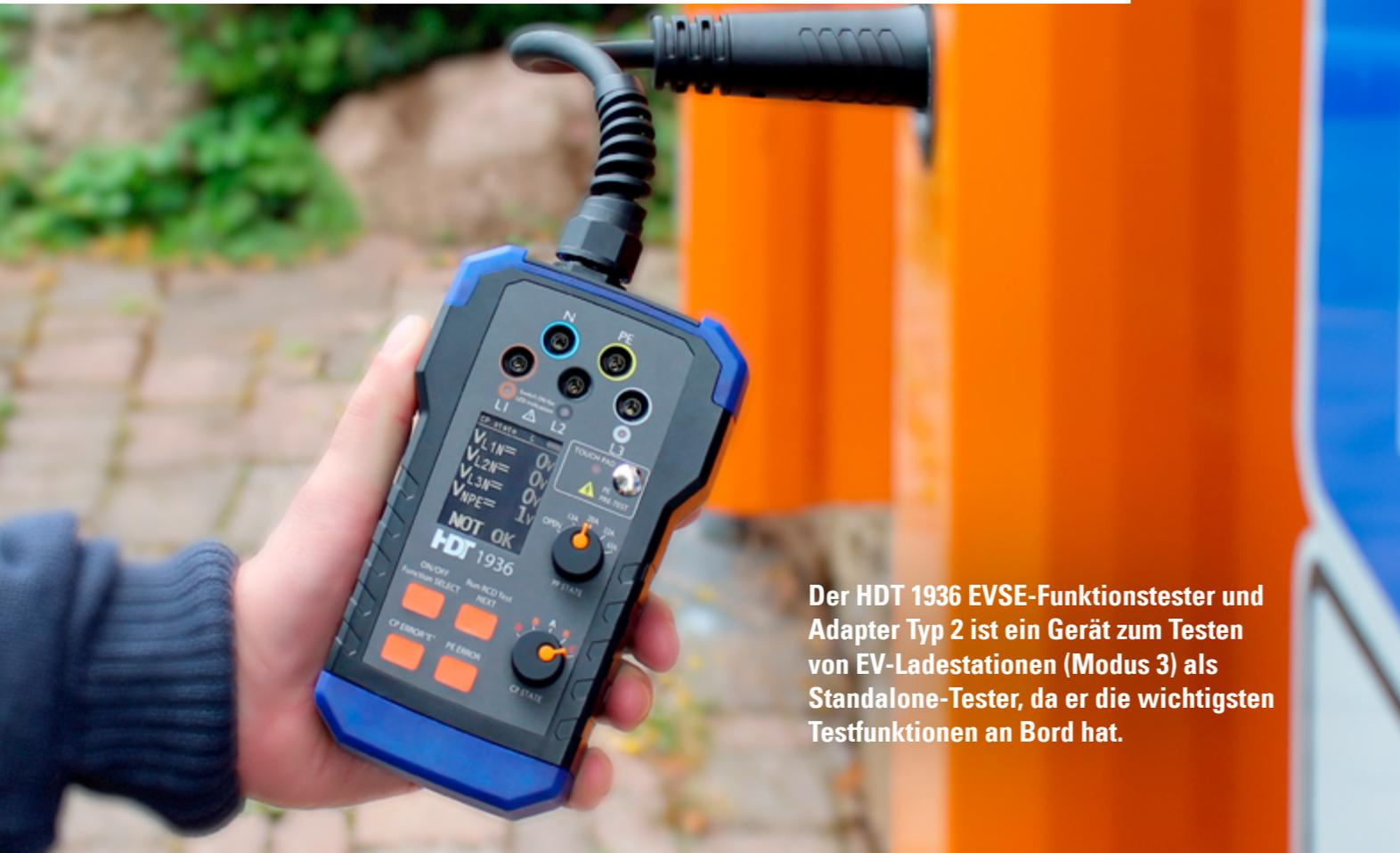
Der HDT 1936 EVSE-Funktionstester und Adapter Typ 2 ist ein Gerät zum Testen von EV-Ladestationen (Modus 3) als Standalone-Tester, da er die wichtigsten Testfunktionen an Bord hat.
