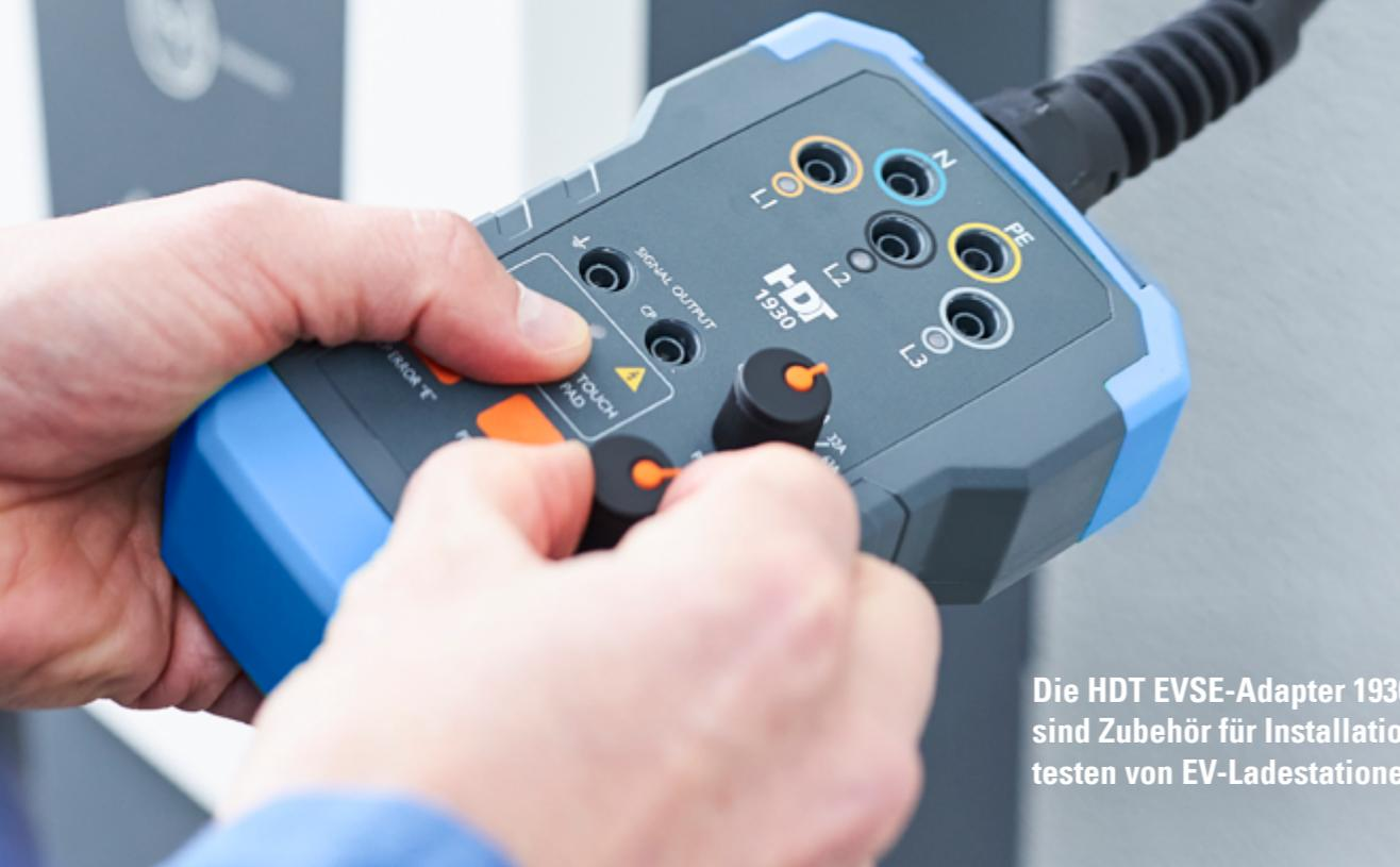
Die HDT EVSE-Adapter 1930 und 1934 sind Zubehör für Installationstester, zum Testen von EV-Ladestationen.
